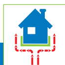
B3 - Prinsippsskisse Protan RadonSafe løst lagt under isolasjonslaget.
